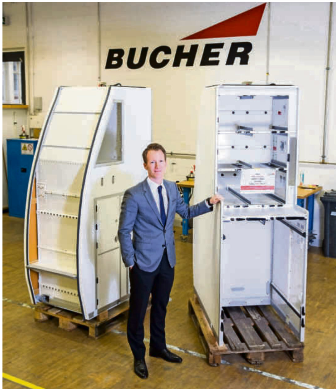
In der Montagehalle: CEO Beat Bulet vor Küchensystem-Monumenten für den Triple Seven.
