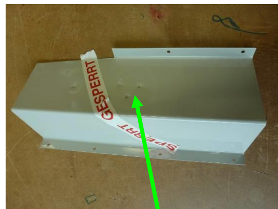
„Ausschussteil“ kann entsorgt werden (eingeschlagen) Wastage can be scraped (smashed with hammer)
